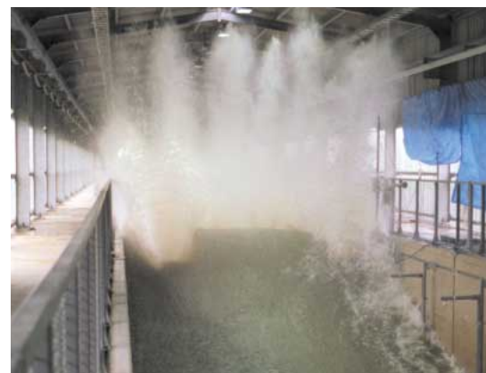
„Freak wave“ im Versuchskanal. Wissenschaftler der TU Berlin lassen hier Miniaturausgaben der Wasserwände zu Testzwecken auf einen Wellenbrecher krachen. Trotz kleinerem Maßstab ist die Energie, die die Wellenfront mit sich führt, bereits gewaltig. (Bild: Meerestechnik – Technische Universität Berlin)
